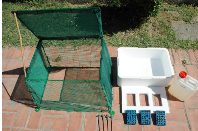
Figura 10. Esempio del materiale necessario per l'allestimento delle stazioni di rilevamento di bioindicazione dell'ozono.
