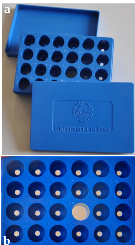
Figura 2. Dettaglio di un kit per l'esposizione di germinelli di tabacco: a) piastra a sezione rettangolare in polistirene come da brevetto (Lorenzini, 1994), con i due appositi coperchi e b) visione d'insieme dei pozzetti identificati da lettere maiuscole in verticale (A, B, C e D) e numeri progressivi in orizzontale (da 1 a 6), opportunamente forati.
